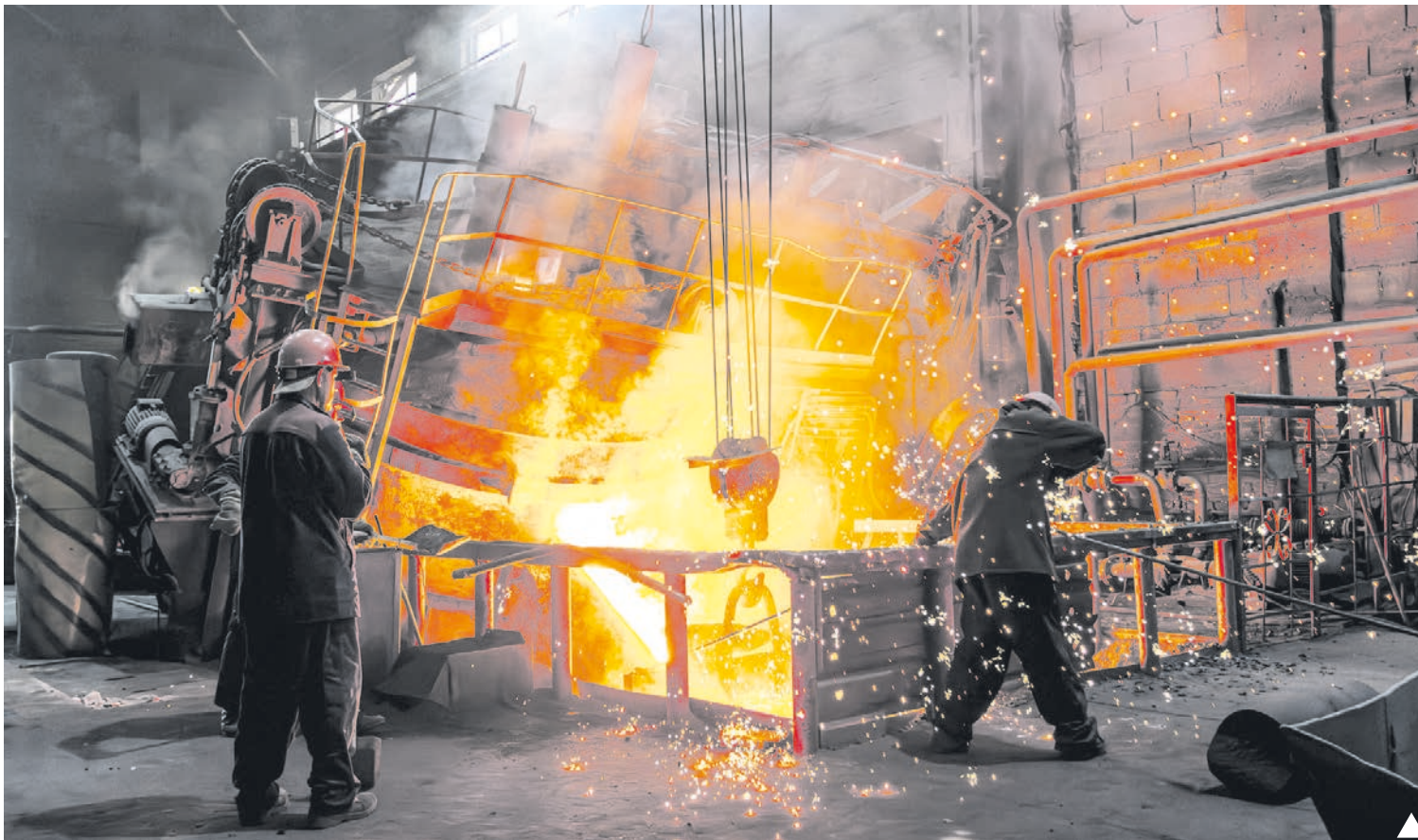
В плавке – сила металлургов. Процесс слива металла в ковш | Фоторепортаж Кирилла Васильева
