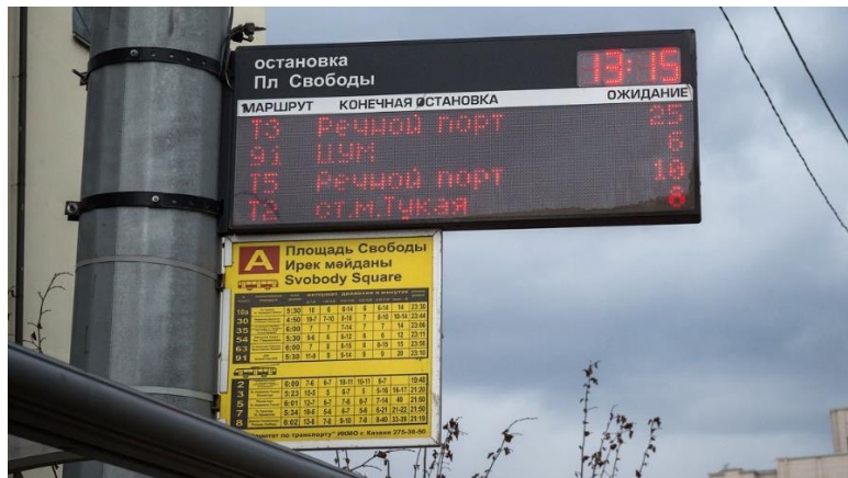
Рисунок 4.2.1 - Электронное информационное табло для общественного транспорта отображает сообщения о номере маршрута, расписании, остановках и справочную информацию
