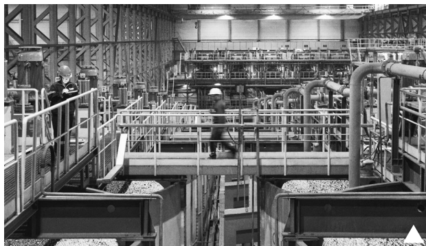
Отделение флотации обогатительной фабрики Томинского ГОКа
